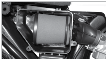
Imagen 17. Filtro de aire.
