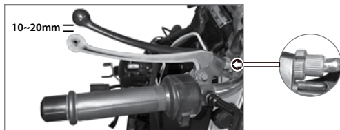
A B Imagen 19. Ajuste de la palanca del embrague.
