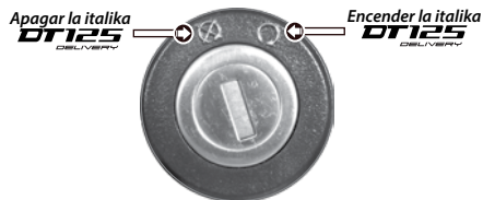
Imagen 7. Interruptor de encendido.
