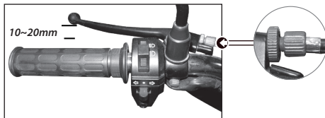
A Imagen 19. Ajuste de la palanca del embrague.
