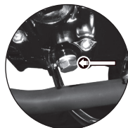
Imagen 15. Ubicación del tornillo de drenado.
