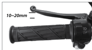
Imagen 19. Ajuste de la palanca del embrague.
