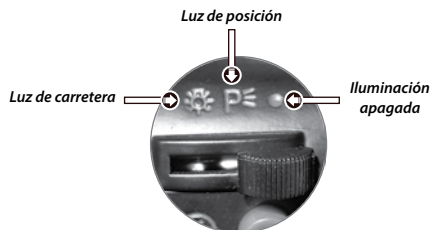
Imagen 2. Interruptor de luz delantera.
