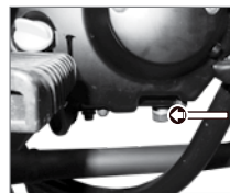
Imagen 15. Ubicación del tornillo de drenado.
